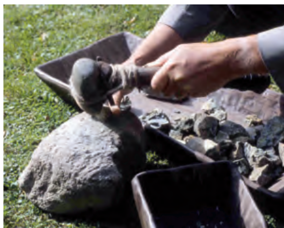
Das Zerkleinern von erzhaltigem Gestein mit einem Rillenschlägel (Schwaz, 1995).
