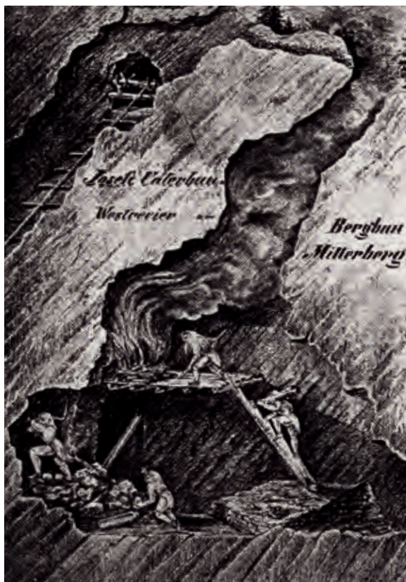
Rekonstruktion des bronzezeitlichen Bergbaus mithilfe des Feuersetzens am Mitterberg.
